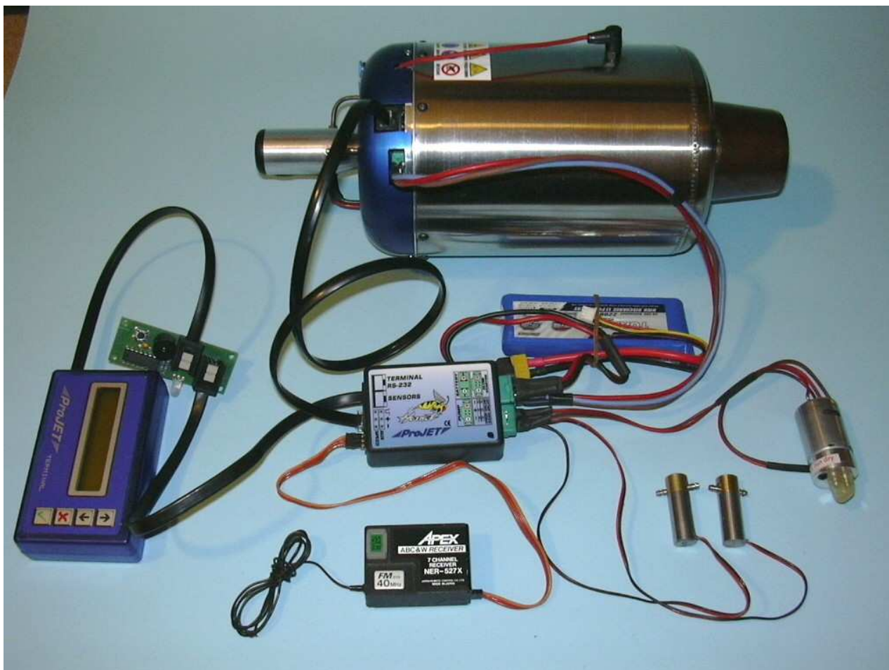
Collegamenti elettrici Turbogetto- ECU
